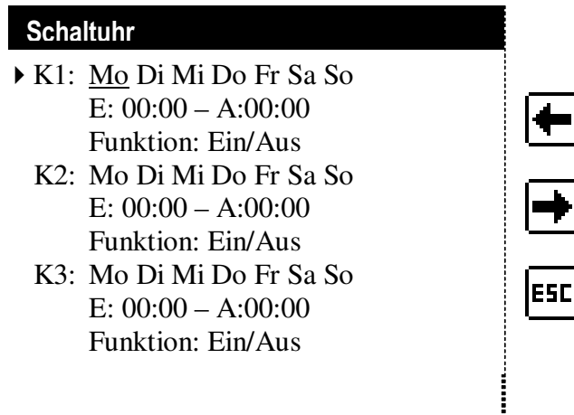
Abbildung 3: Schaltuhr im Änderungsmodus. (Darstellung nicht maßstabsgetreu)
